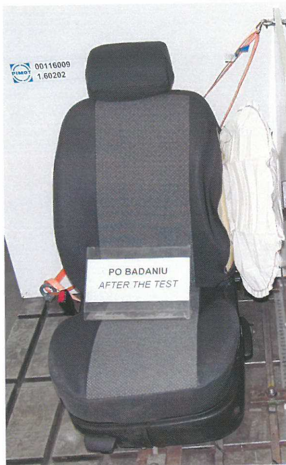
Fot. 3. Pokrowiec po badaniu czasu całkowitego napelnienia bocznej poduszki powietrznej
